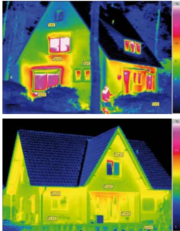
Een warmtescan maakt het warmteverlies in, in rood, zichtbaar; het verschil tussen gewoon isolatieglas en HR++.
